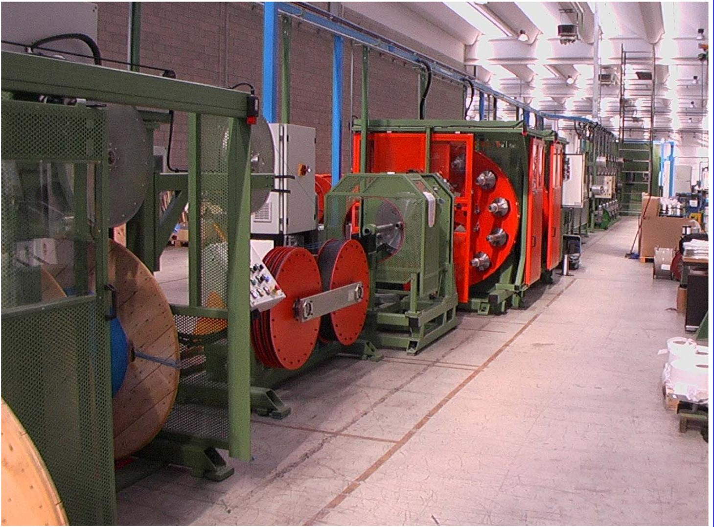
**Linea adatta alla riunitura a passi alternati S-Z, di cavi a fibra ottica, composti da tubetto loose o fibre tight.**
